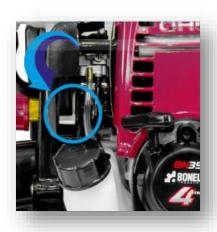
**PASO 4** Girar el shock del carburador para el pase de combustible.
