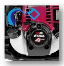
**PASO 1** Llenar el tanque de gasolina de la pulverizadora (utilizar gasolina de 90 octanaje).
