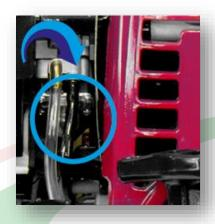
**PASO 3** Girar el cebador para el pase de combustible, que está en la parte superior izquierda del arranque.
