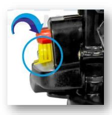
**PASO 5** Girar la palanca de aceleración gradualmente para el previo encendido de la pulverizadora.
